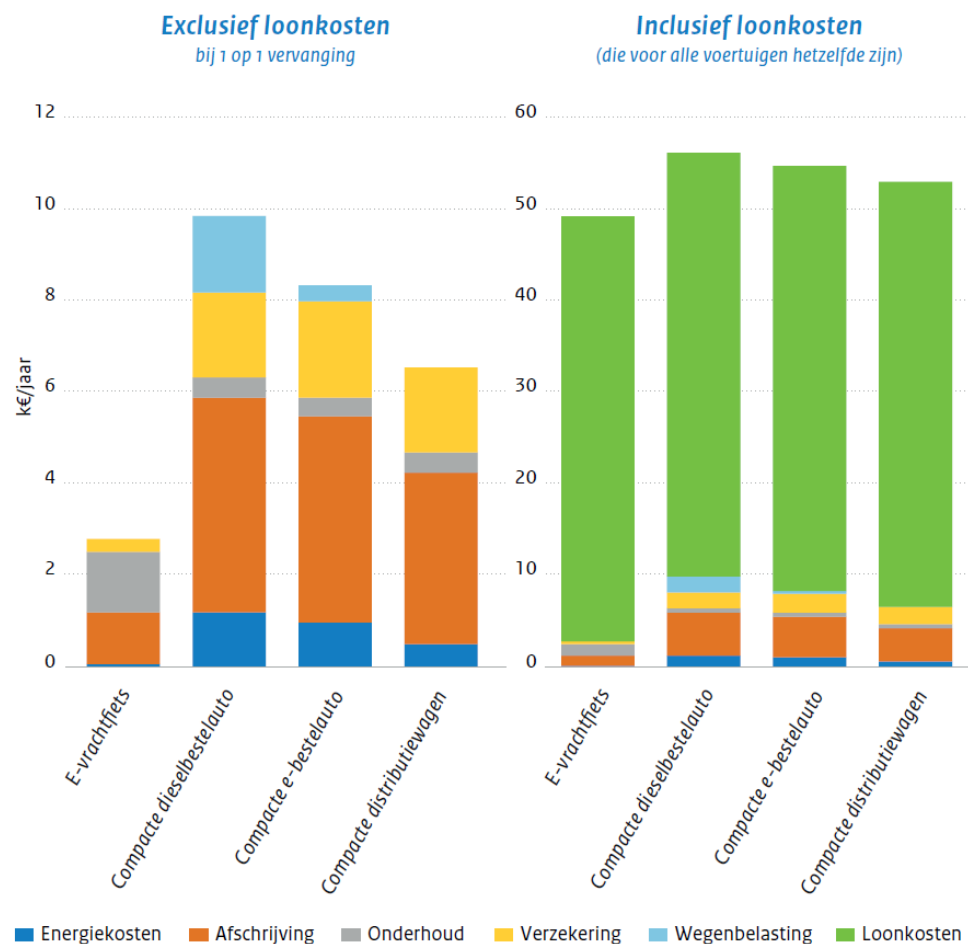
Figuur 6.1 Kosten van een e-vrachtfiets, compacte dieselbestelauto, compacte e-bestelauto en compacte distributie wagen (links) exclusief en (rechts) inclusief loonkosten (die niet verschillen per voertuigtype) bij 1 op 1 vervanging (scenario 1a)
