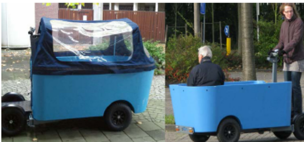
Afbeelding 1. De STINT tijdens een rijproef met en zonder overkapping
